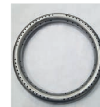
Заготовка из материала X12MФ \phi 150 мм. Выполнено 32 отверстия под углом 60^\circ к центру и 60 отверстий под углом 10^\circ .
