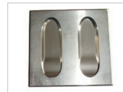
Изготовление пресс-формы подошвы с шероховатостью Ra0,2.
