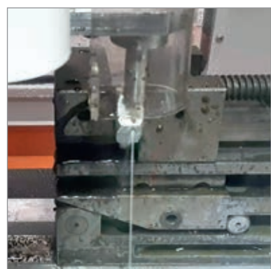
Сверление-прожиг контрольного отверстия на гайке
