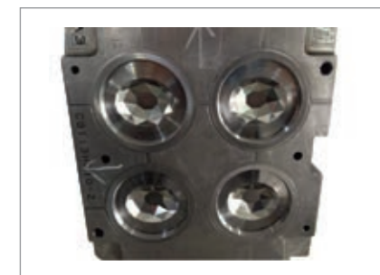
Пресс-форма с шероховатостью Ra0,2.
