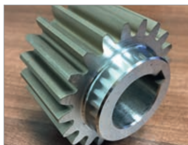
Деталь шестерня. Шероховатость — Ra0,8. Площадь реза — 16132 мм 2 . Время реза — 6 ч 45 мин.
