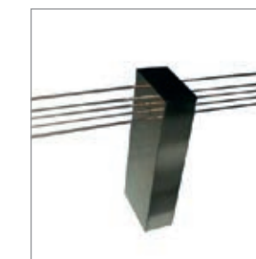
Отверстия диаметром 0,4 мм в заготовке из нержавеющей стали толщиной 10 мм
