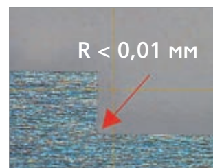
Минимальный радиус в углах менее 0,01 мм.
